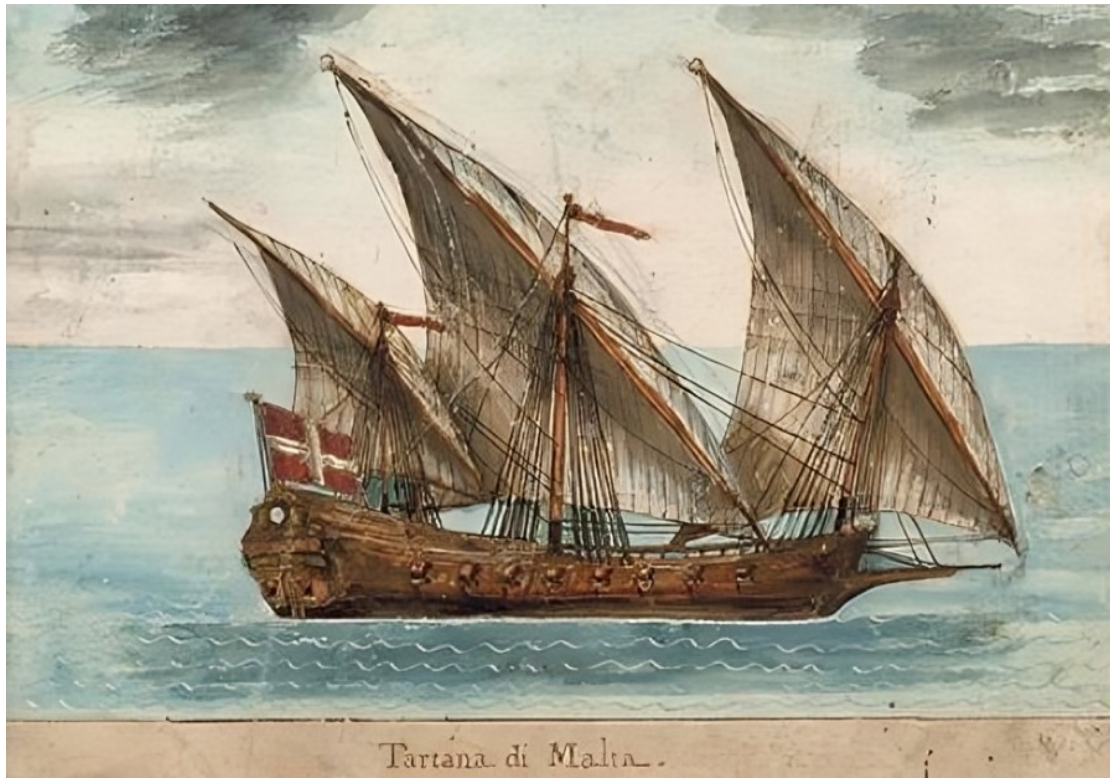
Εικ. 10. - «Ταρτάνα (tartana)· χαρακτηριστικό μεσογειακό ιστιοφόρο του 18ου αιώνα, χρησιμοποιούμενο για παράκτιο εμπόριο και μεταφορές»
